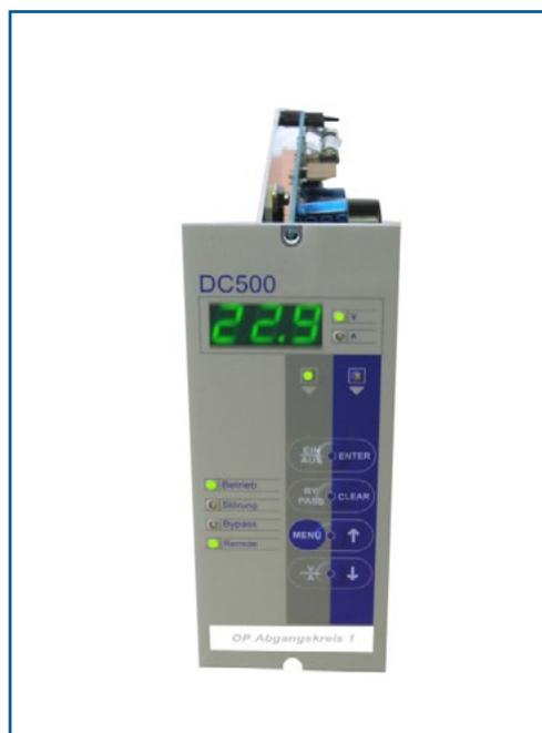
Über die Folientastatur kann der Wandler ein- und ausgeschaltet werden. Zum Test der By-passeinrichtung ist eine manuelle Umschaltung je Wandler auf Bypass integriert. Bei Fernein-schaltung sind die Taster des OP-Wandlers und der Prozessorsteuerung gesperrt.
