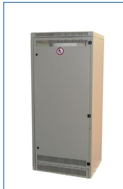
Alle Gehäuse werden pulverbeschichtet und einbrennlackiert produziert. Alle Gehäuse entsprechen der Schutzart IP 20. Die Türen sind rechts angeschlagen. Türen der Standgehäuse sind in einem Winkel von 180° zu öffnen. Zur Anpassung an andere Gehäuse können zusätzlich Gehäusesockel von 100 bzw. 200 mm Höhe geliefert werden..
